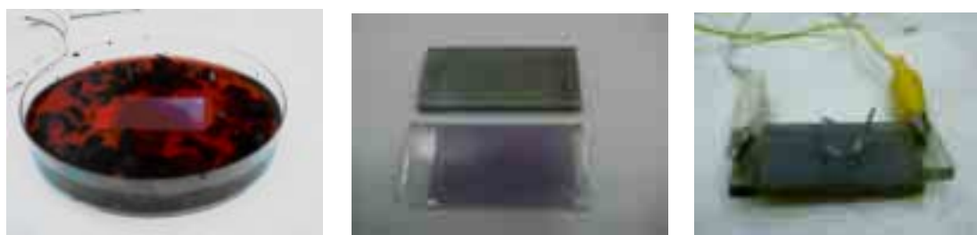
図 色素増感太陽電池の工作（光合成型太陽電池とも呼ばれる）
